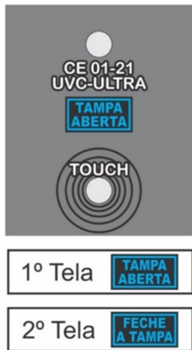
Si después del toque en el sensor touch el sistema identifica que la tapa se encuentra abierta o no cerrada correctamente, el siguiente mensaje de error aparecerá en la pantalla: "TAPA ABIERTA CIERRE LA TAPA" este mensaje permanecerá hasta que la tapa sea correctamente cerrada, volviendo el display a presentar el reloj con FECHA/HORA necesitando que el operador efectúe nuevamente el toque en el sensor touch para que se reinicie el proceso de esterilización.
