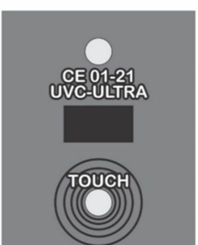
Cuando el sensor touch sea accionado el sistema hará una lectura en el sensor de tapa para garantizar que la misma se encuentre correctamente cerrada, emitiendo una señal sonora con 5 bips, la pantalla se apagará por 2 segundos, tiempo necesario para que las lámparas se calienten y enciendan completamente.
